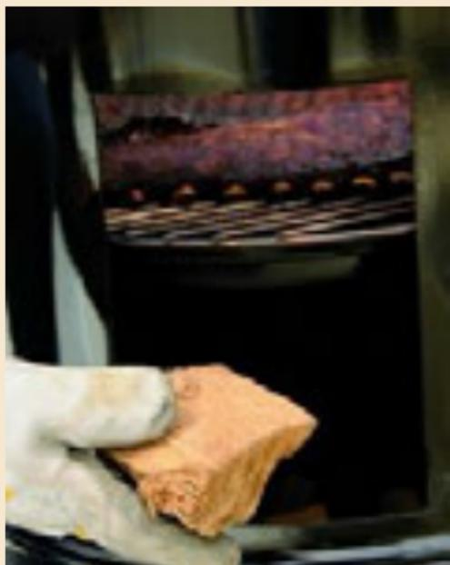
**5.** Sobald die ersten Holzstücke verbrannt sind, die Tür der Brennkammer öffnen und ein bis zwei weitere Stücke auf die Glut legen. Bei geöffneter Tür zügig
